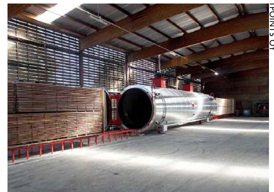
▲ WDE Maspellin toimittamat alipaine-kuivaamot ovat kompakteja.
